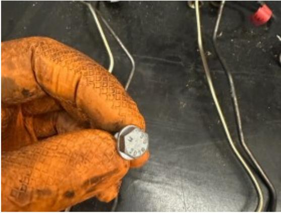
Das ermöglicht, dass die kurzen Schrauben nicht in der Nuss verschwinden und mit der Nuss geführt werden können:
