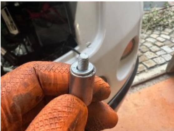
Zwei Muttern in der Nuss hinter der Schraube ginge auch, ist aber in Zwangslage im Motorraum blöd, wenn sie rausfallen.
