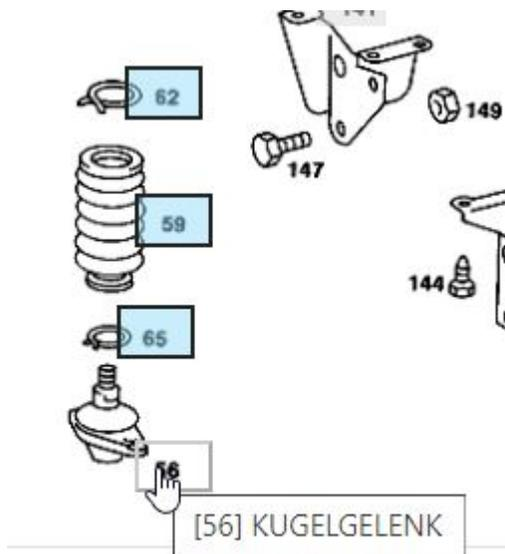
Es geht um die Spannringe #65 (nml) und den Gummibalg des unteren Kugelgelenks Bild #56. Da die Gelenke noch i.O. wirken möchte ich wirklich nur das Gummi drum herum erneuern. Würden da wohl die Manschetten der vorderen Traggelenke passen, hat das schon mal Jemand probiert?
