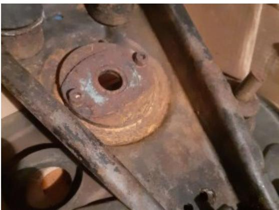
Ich würde gerne die verstärkte Ausführung für einen 220Seb einsetzen, da die originalen Querlenker bereits durch Korrosion stark geschwächt sind. Alternativ könnte ich die Verstärkung auch abflexen, aber eher ungern wenn es so auch passen würde.
