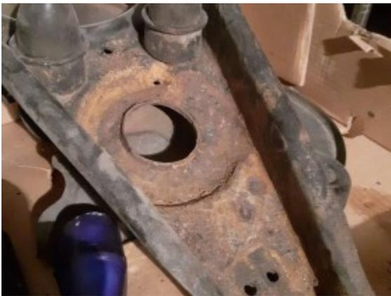
Hier aus einem Schlachtfzg. 280SE 3.5 Cp Flachkühler mit einer Art Verstärkung, die auf der Rückseite angepunktet ist.
