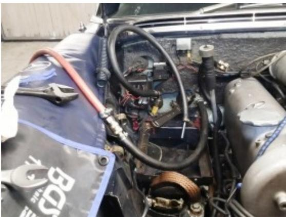
Den York Kompressor habe ich mittels Vakuumpumpe gecheckt, das Vakuum hält er allerdings nur kurz. Da er aber 20 Jahre nicht benutzt wurde, ist vermutlich der Wellendichtring nicht
