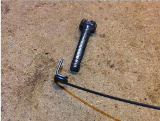
Das Einfädelstück abknipsen und glattschleifen/feilen, und das andere Ende etwas anspitzen, dann fädelt es sich später leichter in die Hohlschrauben der Heizungsventile ein.
