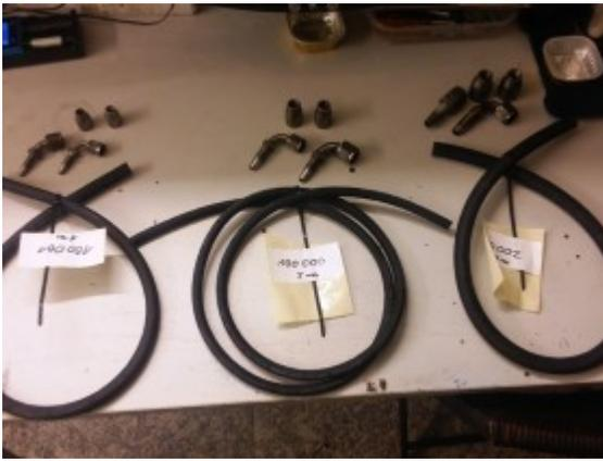
Mit dem von MB gelieferten Schutzschlauch liess sich der Aussendurchmesser soweit vergrössern, dass die Schraubarmaturen Halt fanden:
