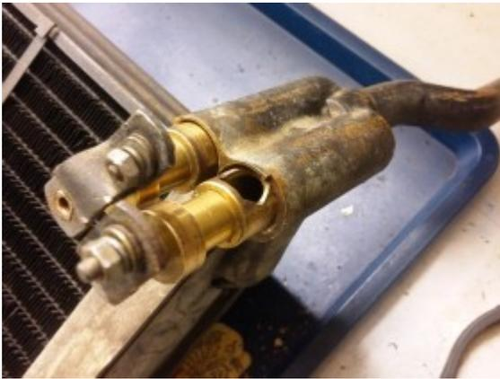
Die runde Verschlusskappe mit den 2 O-Ringen scheint aber bei beiden gleich zu sein (ist beim unteren Bild abgenommen).
