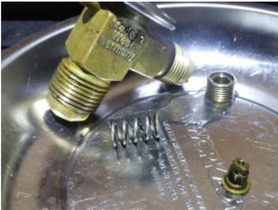
Nun bestimmt die Druckfeder den Öffnungsdruck, hab sie deswegen genau wieder so viele Umdrehungen reingedreht wie vorher rausgeschraubt.
