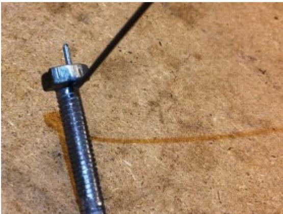
Den Draht im Bereich der Schraube mit einem Heissluftgebläse erhitzt und dann mit dem Akkuschauber 2 Windungen aufgedreht
