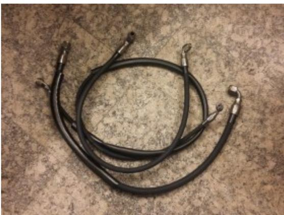
Dann gehts an den Einbau. Konische Kupferdichtungen ebenfalls mit PAG Öl bestreichen, Fittings gefühlvoll auf die Schraubstutzen aufsetzen, damit der Dichtring nicht verrutscht, und kräftig anziehen (30..60Nm, je nach Grösse).
