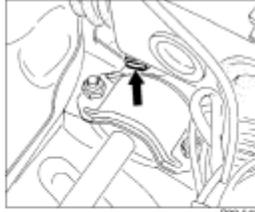
18 Sechskantmutter der Lagerung des Drehstabes am Vorbau links und rechts abschrauben, Haltebügel (21b) abnehmen.
