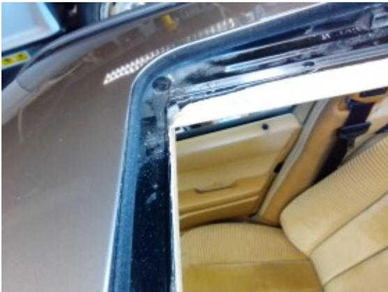
An die neuen Hubwinkel die winkligen Bleche, die mit dem Deckel verschraubt werden, umschauben.
