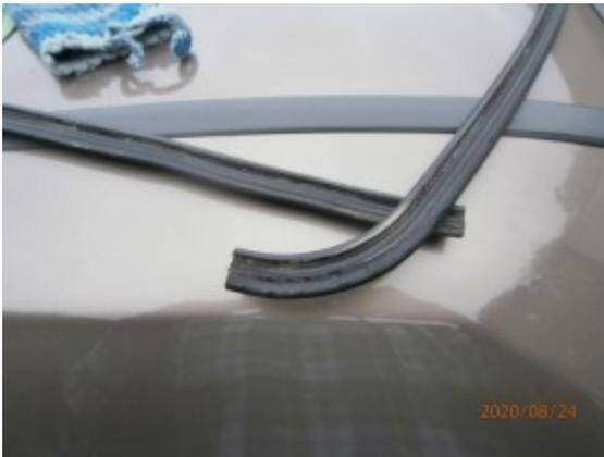
Vor dem herausziehen habe ich mir mit TESA noch zwei Markierungen auf Dach geklebt. Damit sicher gestellt ist, dass die neue Dichtung auch da hinkommt wo die alte sass.
