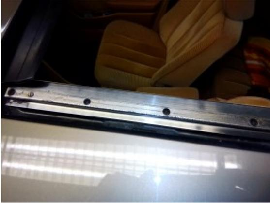
den Regenablauf hinter den Hubwinkel aufgeklippt und den Schubalken vom Hubwinkel abschrauben.
