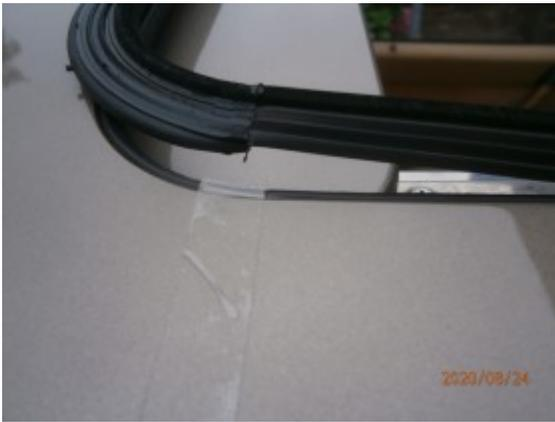
Beim hereusziehen der Dichtung ist mir allerdings aufgefallen, das es doch sinnvoll erscheint, den Windabweiser auch zu demontieren. Das erleichtert das Säubern und den einbau der neue Dichtung.
