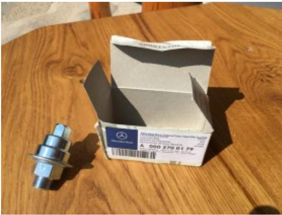
Man sieht hier den Inbus zum einstellen des Druckes (da kommt der Unterdruckanschluss dann hin) ...
