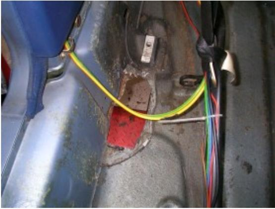
Wie sieht das jetzt aus mit dem schweissen, stumpf einschweissen oder Absetzen und drauf. Muss ja hier wohl eh durchschweissen im Pilgerschritt, da es ja dicht sein muss, oder punkten und Dichtmasse 🤔
