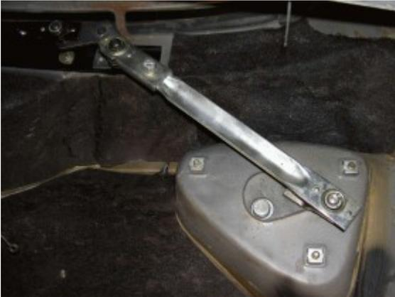
Am oberen Ende der Verbindungsstange zum Wischergestänge hin sollten ein paar Grad Winkel nach links vorne sein, sonst dreht sich das Ganze in die falsche Richtung. Unbedingt zuerst ohne Wischerarme probieren!
