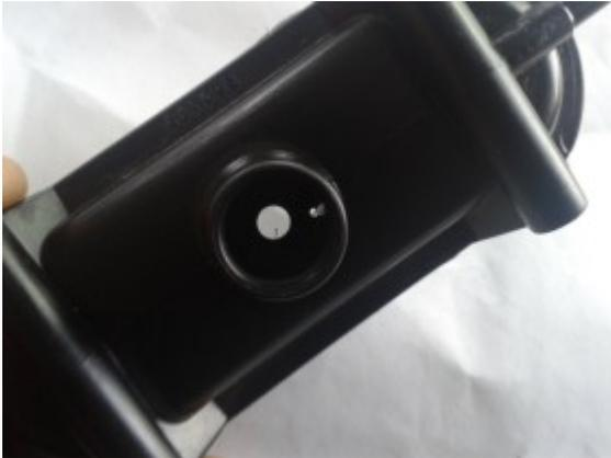
Nun die Stangenführung mit einer Entlastungsbohrung versehen und das Teil wieder zusammengeflickt.
