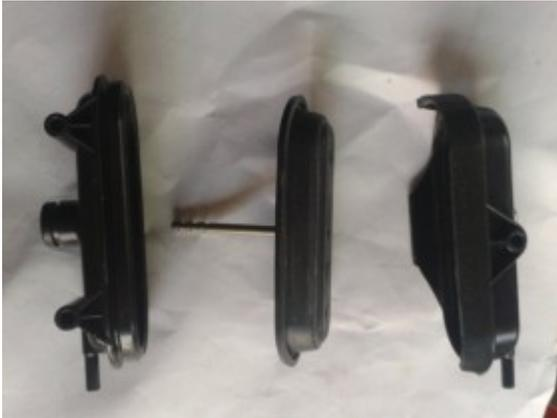
Danach ist mir das Element auf der Suche nach dem nicht vorhandenen Dichtring explodiert. Dadurch konnte ich die eigentlich nicht sichtbare Membrane mit Kolbenstange untersuchen. Nach über 200.000 Zyklen, (habe mit diesem Element alle bisherigen Tests durchgeführt) keine erkennbaren Beschädigungen am Gummi!
