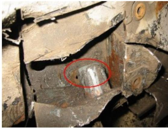
Hier sieht man auch den Dreck, der sich in der Tasche von Verstärkungsprofil / Träger schön angesammelt hatte. Durch die versenkte Schraube und das Ablaufloch der Hülse an der Äußeren Trägerwand in den Längsträger sorgt auch immer für Dreck und Feuchtigkeit im Träger in dem Bereich.
