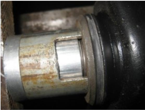
Hierbei drückt nun die äußere Hülse gegen die Scheibe und somit die Gummipuffer, und die innere Hülse schiebt den Sprengring über den Konus auf die Lagerhülse - im Idealfall bis in die Nut.
