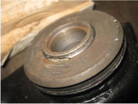
Ach ja, warum hat die äußere Hülse eine Aussparung? Zum Einen kann man dadurch sehen, wie weit man schon gepresst hat. Zum Anderen dient dies zum Entfernen des Sprengringes bei der zuvor zu erfolgenden Demontage. Hierzu wird die innere Presshülse herausgenommen, dann presst man wie oben das Ganze nur mit der äußeren Hülse zusammen bis der alte Sprengring drucklos freiliegt, und man kann ihn durch das Aussparungs-Fenster mit einem Schraubendreher o.ä. aus der Nut hebeln.
