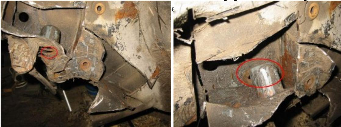
Hier sieht man auch den Dreck, der sich in der Tasche von Verstärkungsprofil / Träger schön angesammelt hatte. Durch die versenkte Schraube und das Ablaufloch der Hülse an der Äußeren Trägerwand in den Längsträger sorgt auch immer für Dreck und Feuchtigkeit im Träger in dem Bereich.
