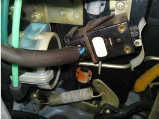
Dieser Schalter wird durch das Gestänge von der Unterdruckverstellung der Lüftung betätigt. Jedoch ist eine Verpressung am Halter gelöst, so dass der Schalter nicht mehr ausgelöst werden konnte. Das geh ich jetzt mal reparieren. Aber was macht dieser Schalter? Stellt er den Kompressor an?
