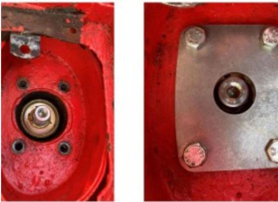
Es lassen sich aber auch Dichtungspapier oder einfach 4 Unterlegscheiben pro Platte zur galvanischen Trennung bei unlackierten Fahrzeugen dazwischen montieren. 😊
