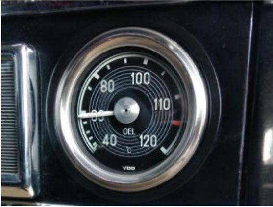
Bilder: nach 30km Autobahnfahrt bei 5°C Umgebungstemperatur, Zylinderkopftemperatur 79°C, Motorblocktemperatur unten: 70°C.
