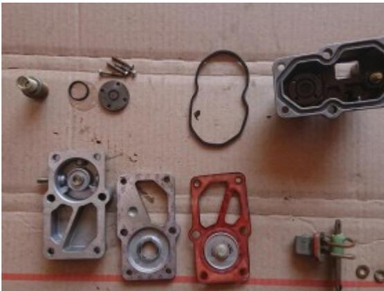
Alle Einspritzventile demontiert und gegen die neuen Bosch einschl. Dichtung etc. ausgetauscht. Die Original Einspritzventile konnte ich nicht prüfen, denke aber das diese am Ende sind und wie Volker schon schrieb von 1980, ergo noch die Ersten.
