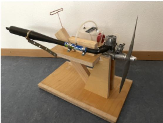
OS MAX 40: 6.5 ccm, erhofte 1+ PS mit Resonanz bei 14 tu/min - made anno 79 in Japan
