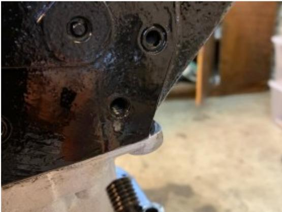
Ich war wieder zu schnell und habe eine Inbusschraube von den Kurbelwellenriemenscheibe durchgedreht... Also mal vorsichtig, Loch gut gesäubert, guten Inbusaufsatz mit einem Hammer in die Schraube getickt und ausgedreht.. Danach den Schwingunstilger abgezogen.
