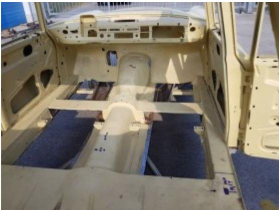
Und auf diesen Träger ist zunächst das Holz geschraubt. Dann wird das bei (nicht ganz frühen) Flossen einteilige Armaturenbrett-Polster montiert (geschraubt und geclipst), dann die Chromleisten, dann die ganzen Instrumente, Schalter, Blenden, etc.
