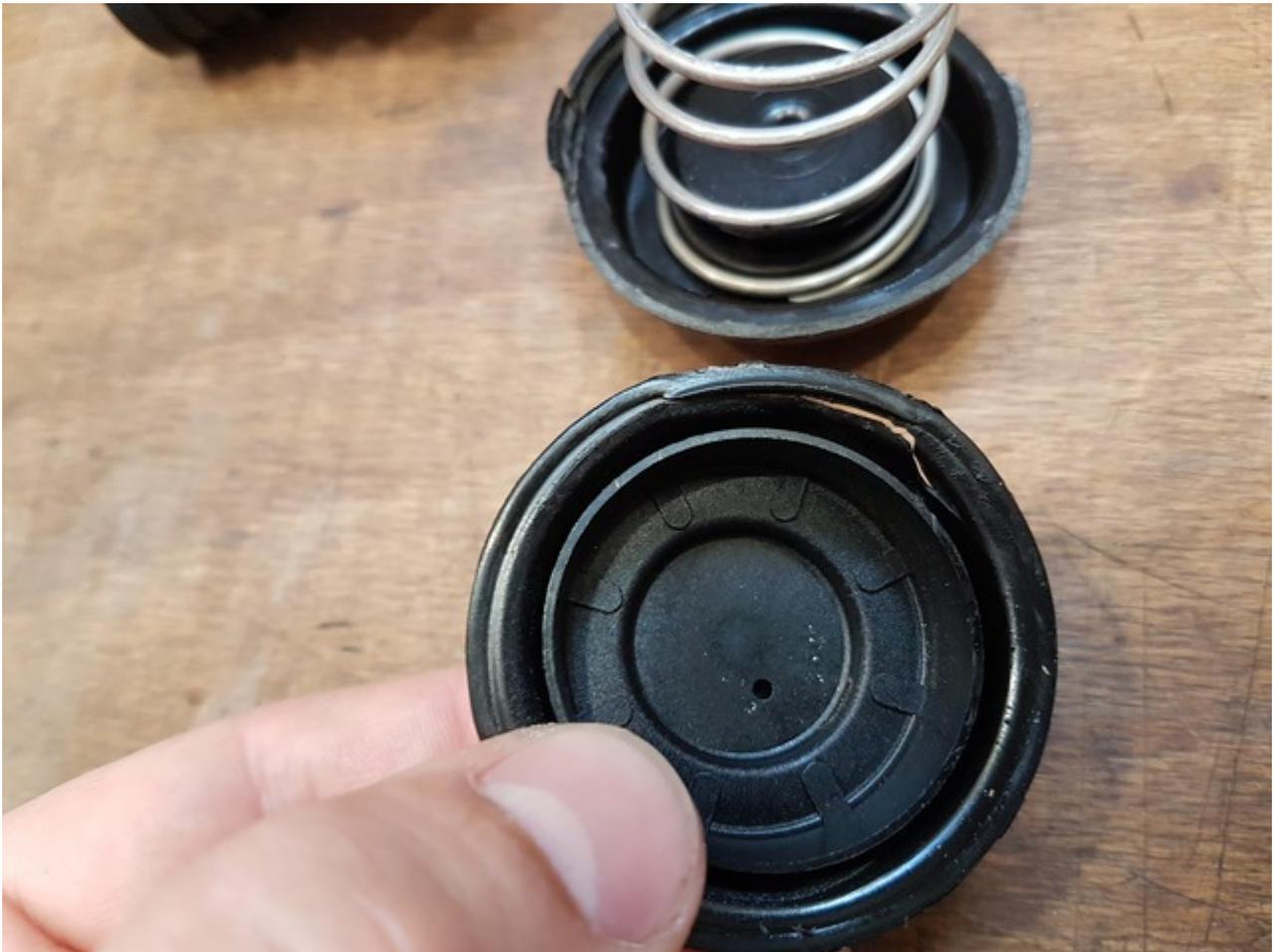
Habe am WE ein (noch!) funktionierendes Gebrauchtteil verbaut. Saugt man (mit dem Mund) am Unterdruckanschluss an, hört man es im Ventil "klacken" wenn der Durchgang freigegeben wird. Ist ziemlich eindeutig feststellbar. Beim defekten Ventil war das anders, da hat man nur noch Luft angesaugt.
