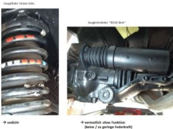
Mein Problem: Das BOGE-Bein hat vermutlich keine Wirkung mehr und kann die beiden Pendelachs-Hälften nicht mehr auseinander drücken. Gleichzeitig ist der linke Gummibalg undicht, so dass der gesamte Wagen ca. 2 Stunden nach dem Aufpumpen links auffällig tief runter hängt.
