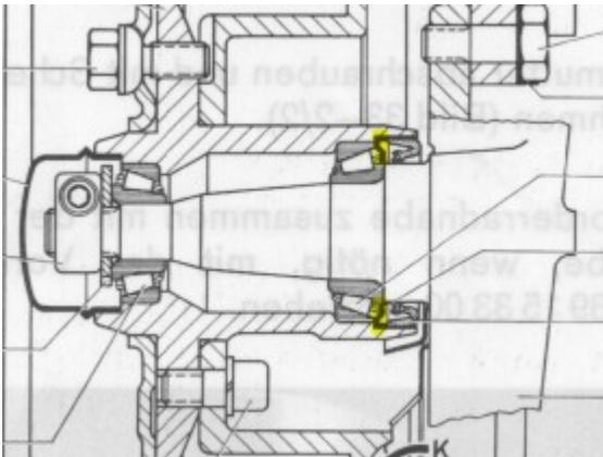
Legt man sich den Ring auf das Lager, dann kann man auch sehr schön sehen, dass nur in einer Ausrichtung - wie Hawa schrieb - der Ring nicht am Käfig des Lagers schleift:
