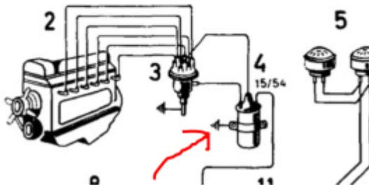
Was passiert eigentlich wenn man doppelte Entstörung einbaut, zu viel Widerstand für die Zündspule?
