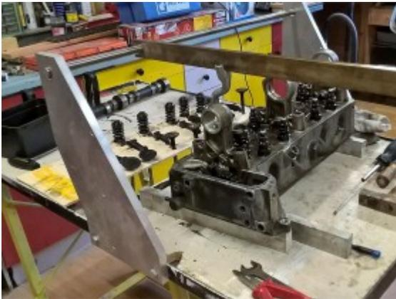
Aus Resten, ich wollte mir mal eine CNC - Fräse bauen , scheiterte aber am fehlenden Werkzeug , zwei Seitenteile , ein Paar Löcher gebohrt, eine Rundstange und ein Flacheisen aus Messing. Das ganze sitzt auf einem Tisch Hydraulisch hoch zum Hochheben für Rasenmäher .
