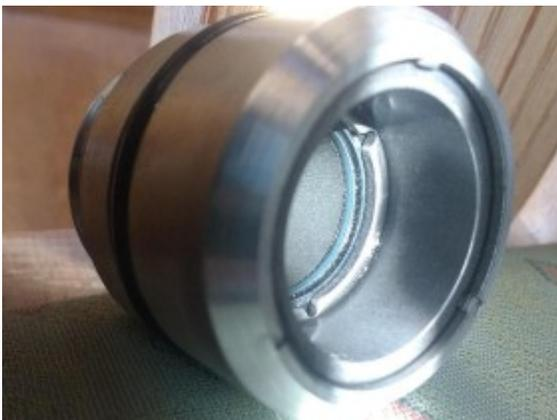
Die mir vorliegenden Kolbenstangen haben alle einen Durchmesser von 22 mm. Dafür bekommt man keine Norm-Dichtringe.
