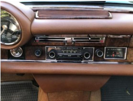
Außerdem hab ich mir einen Vorverstärkerausgang und einen zusätzlichen Eingang einbauen lassen. An diesen hab ich einen DAB+ Receiver angeschlossen, den ich klappbar unter dem Armaturenbrett eingebaut habe.
