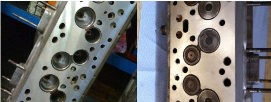
Der leicht quer stehende ist aus einem 170 PS Motor und jetzt in der Flosse (Man beachte die gekürzten Ventileführungen 😊). Der auf dem blauen Papier ist aus einem 160PS Motor, den ich mal zerlegt hatte.
