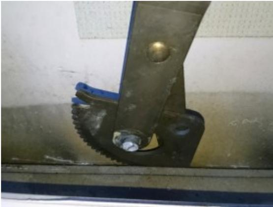
An der Fensterhebermechanik ist ein Gussteil gebrochen (orangefarbener Kreis):
